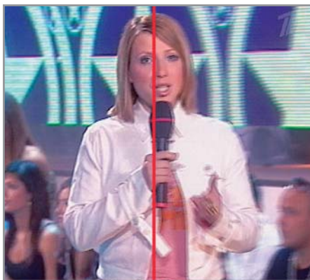
Фильтр деинтерлейсинга позволяет устранить неприятный эффект «гребенки» (результат работы — слева)
