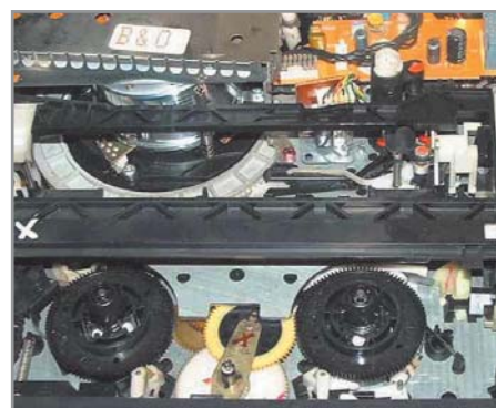
Пластмасса и штампованная жечь вместо алюминиевого шасси
