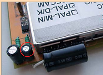
Дополнительно установленные конденсаторы в цепи питания тюнера
