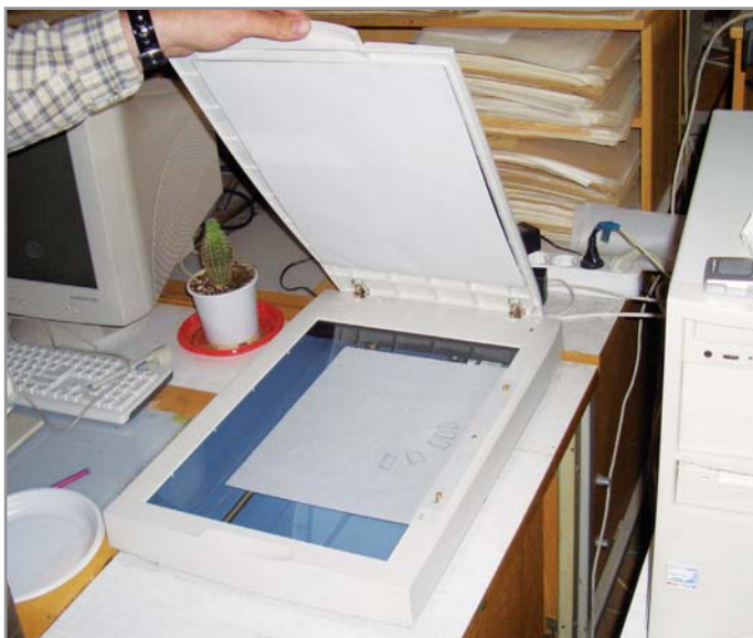
Планшетный сканер со штифтами для фиксации кальки с изображением
