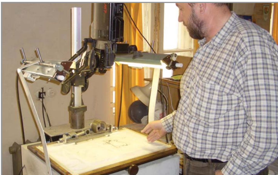
Станок для покaдровой съемки позволяет оперативно перенести в компьютер черновой вариант анимации
