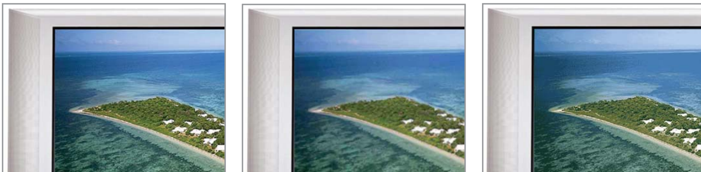
Слева направо: 1 — исходное изображение, 2 — сжатие методом JPG, 3 — сжатие методом GIF. Потеря качества присутствует в любом методе компрессии, но визуально это выглядит совершенно по-разному
