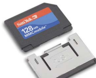
Формат MMCmobile объединяет компактность RS-MMC и высокую скорость MMCplus
