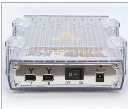
FireWire вполне подходит для подключения внешних жестких дисков
