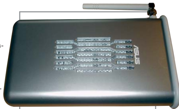
ASUS WL-HDD: внешний накопитель и точка доступа Wi-Fi в одном флаконе
