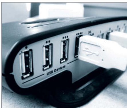
Одно из достоинств интерфейса USB — хабовая архитектура
