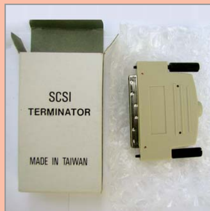
Установка терминаторов обязательна для интерфейса SCSI
