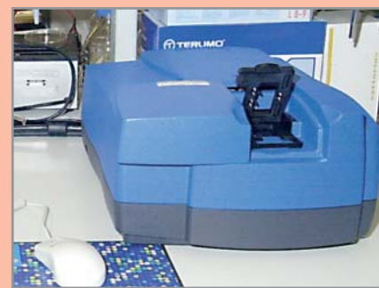
Генетический анализатор GenePix 4000A позволяет считывать информацию с ДНК
